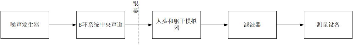
图 5 人头和躯干模拟器校正系统图
